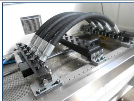
Camera di test con tubi in configurazione di prova
